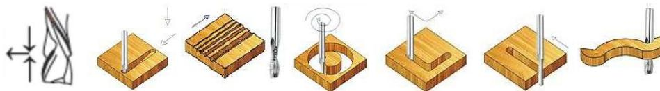
**Zastosowanie** frezy spiralne pełnowęglkowe Z-2+2 GL z układem ostrzy skośnych pozytywno negatywnych. Do frezowania drewna, sklejki, płyt MDF, wiórowej. **Przeznaczone** do prac na maszynach numerycznych CNC. **Posuw** od 10 do 20 m/min w zależności od średnicy narzędzia i rodzaju obrabianego materiału
