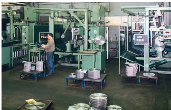
Шлифовка и натяжение корпусов дисковых пил.
