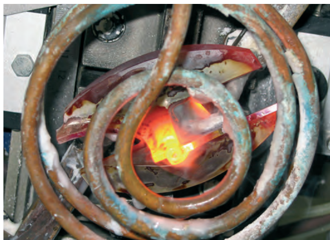
680°C - несколько секунд - и пайка завершена.
