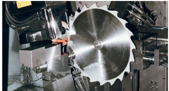
Заточка твёрдосплавных зубьев.
