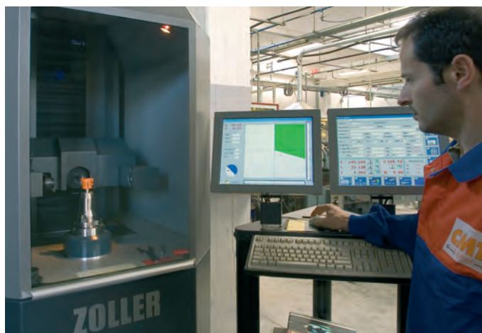
Полностью автоматизированная система измерения CMT.
