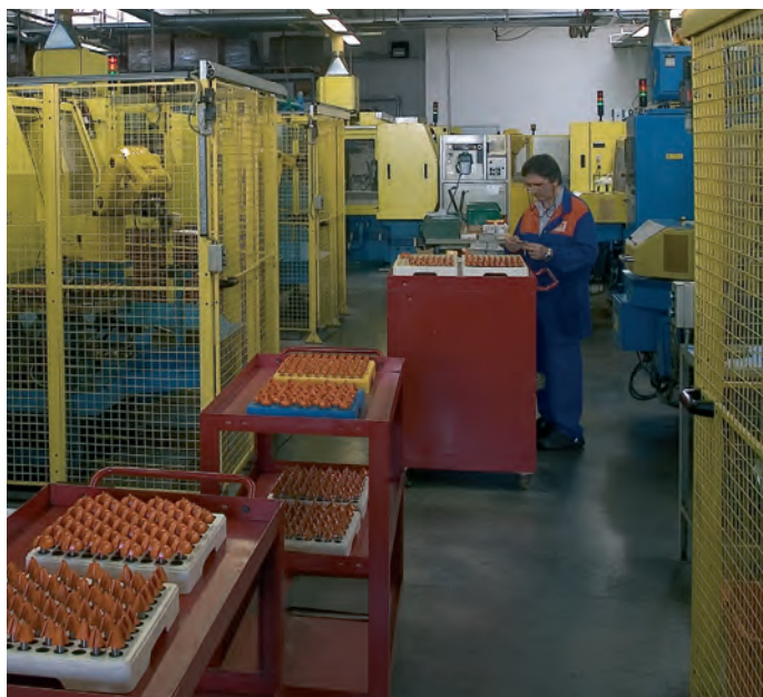
Загрузка фрез в автоматический многошпиндельный роботизированный заточный станок с ЧПУ.
